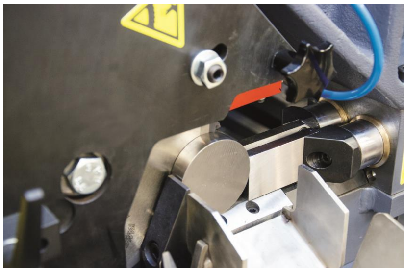
Etau en amont et en aval
