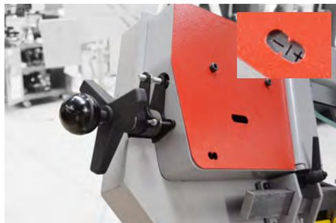
La tension de la lame de scie se fait manuellement en tournant la molette de commande située directement sur le bras de la scie et la bonne valeur de tension est sécurisée par un système électronique qui ne permettra pas de faire fonctionner une machine sans tension correcte ou d'arrêter la machine au moment où la lame de scie se casse.
