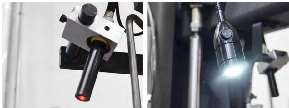
Un laser Liner assure un marquage précis de l'emplacement de la future coupe. La ligne laser rouge indique clairement l'emplacement de la coupe, offrant à l'opérateur une vue d'ensemble précise et permettant de mesurer précisément la longueur requise.
