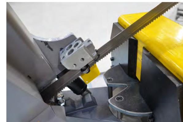
Pour garantir des coupes précises et de qualité, la scie à ruban est équipée de deux cubes de guidage dotés de segments en carbure sur trois faces. L'un de ces cubes est réglable, permettant de le positionner à une distance optimale du matériau, minimisant ainsi la déflexion de la lame et garantissant une coupe précise. Le second cube, fixe et non réglable, est conçu pour assurer la stabilité de la lame après la coupe.
