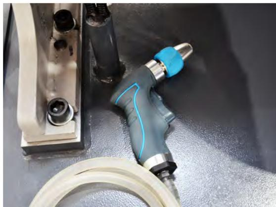
Pour prolonger la durée de vie de votre scie à ruban et garantir un confort d'utilisation optimal, il est important de maintenir un espace de travail propre. Pour faciliter ce nettoyage, les scies à ruban peuvent être équipées d'un pistolet de nettoyage.
