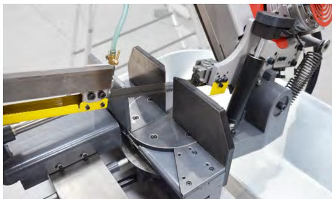
Le serrage du matériau est assuré par un étau doté d'une poignée de serrage et d'un levier de fixation excentrique. Lors d'une coupe d'angle, l'étau de serrage peut être déplacé de gauche à droite. Tous les éléments de commande de la machine sont situés sur un panneau fixé directement sur le socle.
