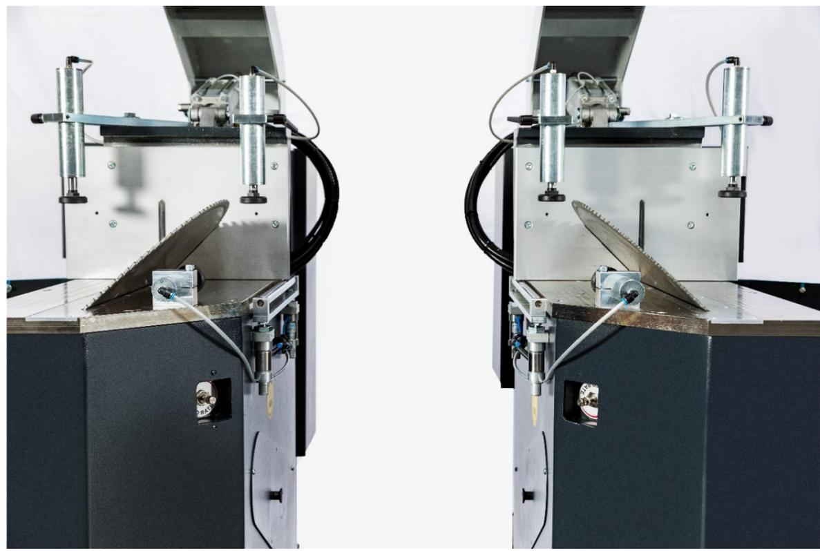
Basculement des têtes à 45° vers l'intérieur pour des angles complexes
