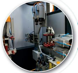
Système de servocommande CNC fournissant un mouvement à 8 axes
