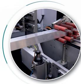
Réalisation d'opérations sur les quatre faces de profilés en aluminium et en PVC telles que le fraisage
