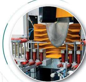
Scie à servocommande d'un diamètre de Ø 550 mm avec une coupe précise entre 45° et 135°
