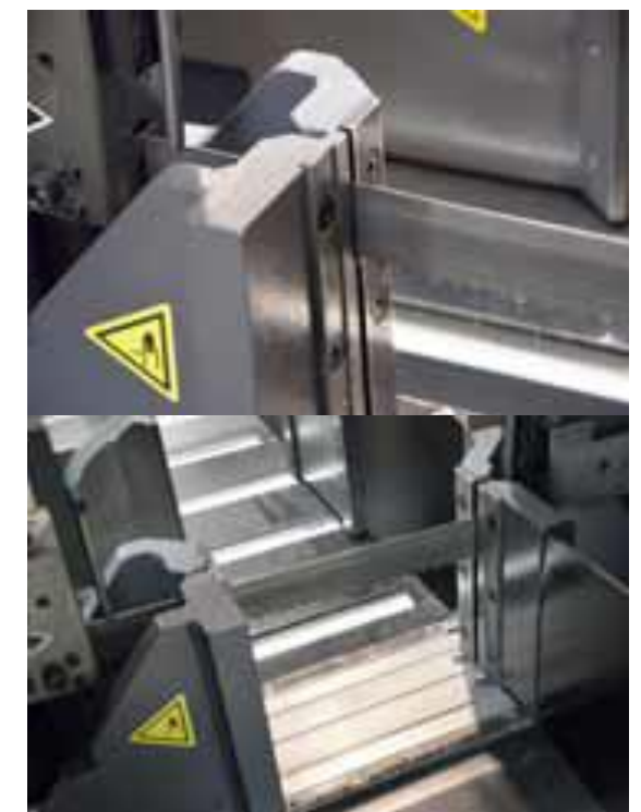
Mors d'étau assurant un serrage optimal avec une faible usure
