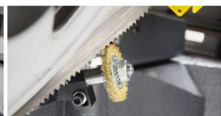
L'actionnement de la brosse à copeaux est toujours synchronisé avec la vitesse du ruban, ceci afin que le nettoyage soit idéal.
