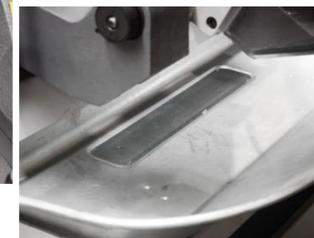
Le grand bac à copeaux, facile d'accès et muni d'un tamis d'égouttage, empêchera les fuites de liquide de refroidissement.
