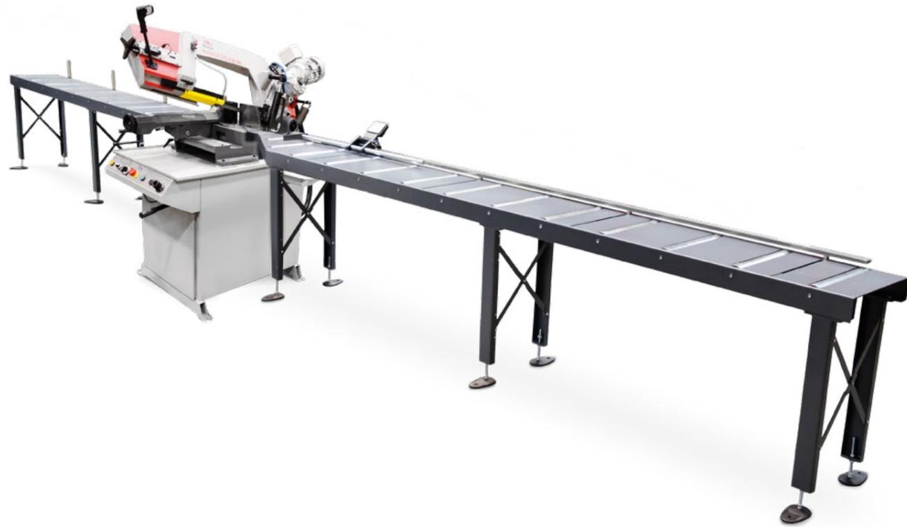
Les convoyeurs à rouleaux et les butées de mesure de type M rendent la manipulation de la matière plus confortable.
