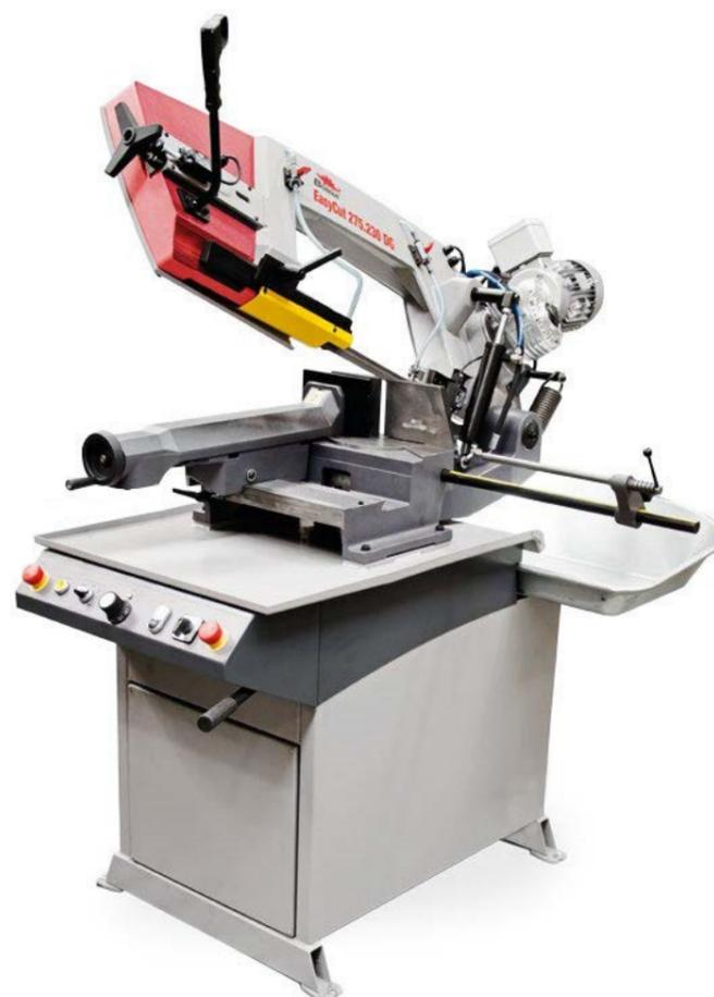
Les coupes angulaires peuvent être réalisées de 60° à droite à un angle de 45° à gauche et elles peuvent être réglées rapidement.
