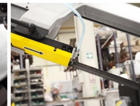
Le bloc de guidage du ruban mobile pourra être réglé de manière à toujours être au plus près de la matière à découper.
