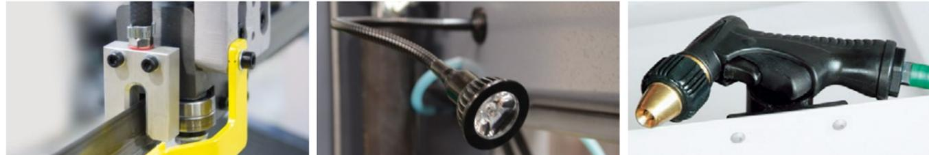
La micro-pulvérisation applique un brouillard d'huile sur les pointes des dents et sur les côtés du ruban.
