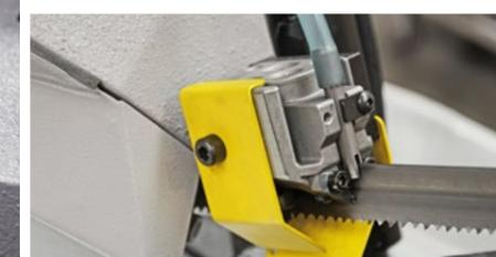
Le guidage du ruban se fait à l'aide de plaquettes de carbure, qui garantissent que la coupe sera réalisée avec une très haute précision.
