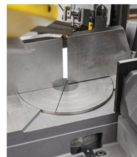
Grâce à la table rotative, le plan de travail ne peut pas être coupé (pas de plaque d'usure).
