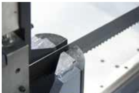
Mors d'étau avant proche du ruban pour un serrage efficace
