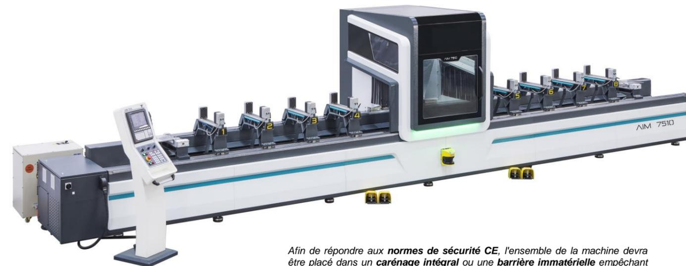
Afin de répondre aux normes de sécurité CE, l'ensemble de la machine devra être placé dans un carénage intégral ou une barrière immatérielle empêchant l'accès aux éléments mobiles (cabine d'usinage, butée latérale, ...).
