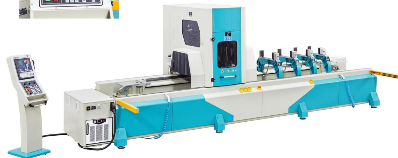
Afin de répondre aux normes de sécurité CE, l'ensemble de la machine devra être placé dans un carénage intégral ou une barrière immatérielle empêchant l'accès aux éléments mobiles (cabine d'usinage, butée latérale, ...).
