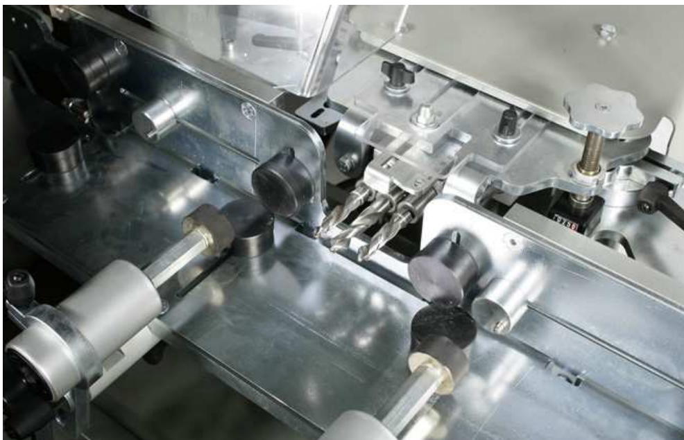
Tête de perçage à 3 broches & serrage pneumatique par 2 vérins
