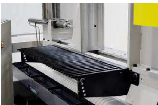
Tablier de sortie
