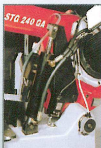
VERIN MONTEE/DESCENTE DE L'ARCHET PALPEUR D'EFFORT DE COUPE/POTENTIOMETRE BUTEE HAUTE
