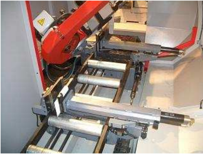
Chemin avec étai avance-barre
